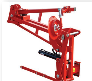
Гидравлический маркер колеи по всей рабочей ширине, колея по центру (только для складных рам)
